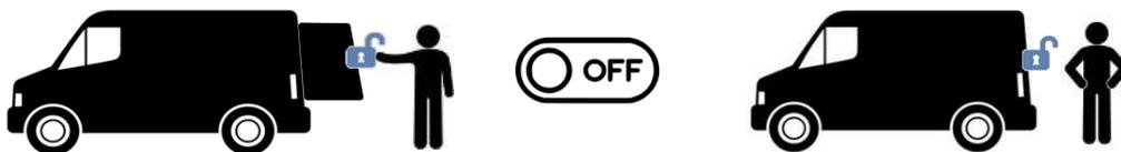
En particulier, il est possible de bloquer le serrure à l'ouverture, en le laissant toujours ouvert, en agissant sur la came de verrouillage spécifique présente sur la partie interne de la serrure. Une fois la porte ouverte et le serrure ouvert, il suffit de tourner la came en position d'arrêt avec le bout de la clé ou un tournevis pour que le serrure reste toujours ouvert.
